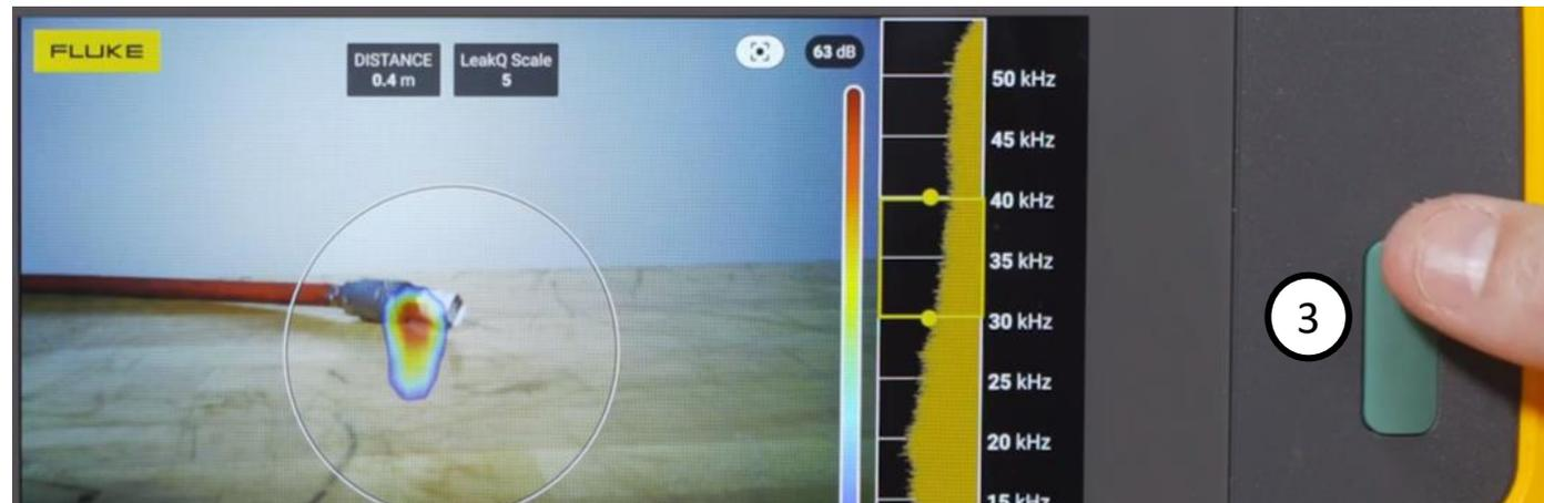
3. 上部に距離と規模（重症度スケール）が表示されていることを確認して、緑色の撮影ボタンを押します。ボタンを離れたらii900の視野が動かないように保持します（約3秒）。
