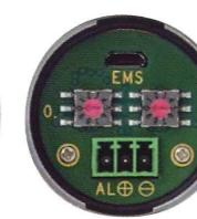
Thermalert 4.0は、2線式配線で電源供給とアナログ出力を同時にサポート
