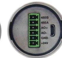
アナログ出力とRS-485通信に対応した6ピン端子台仕様のThermalert 4.0
